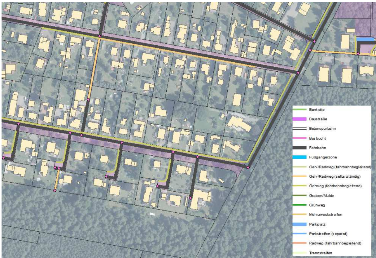
Abb.: Übersicht Verkehrsflächenbefestigung
